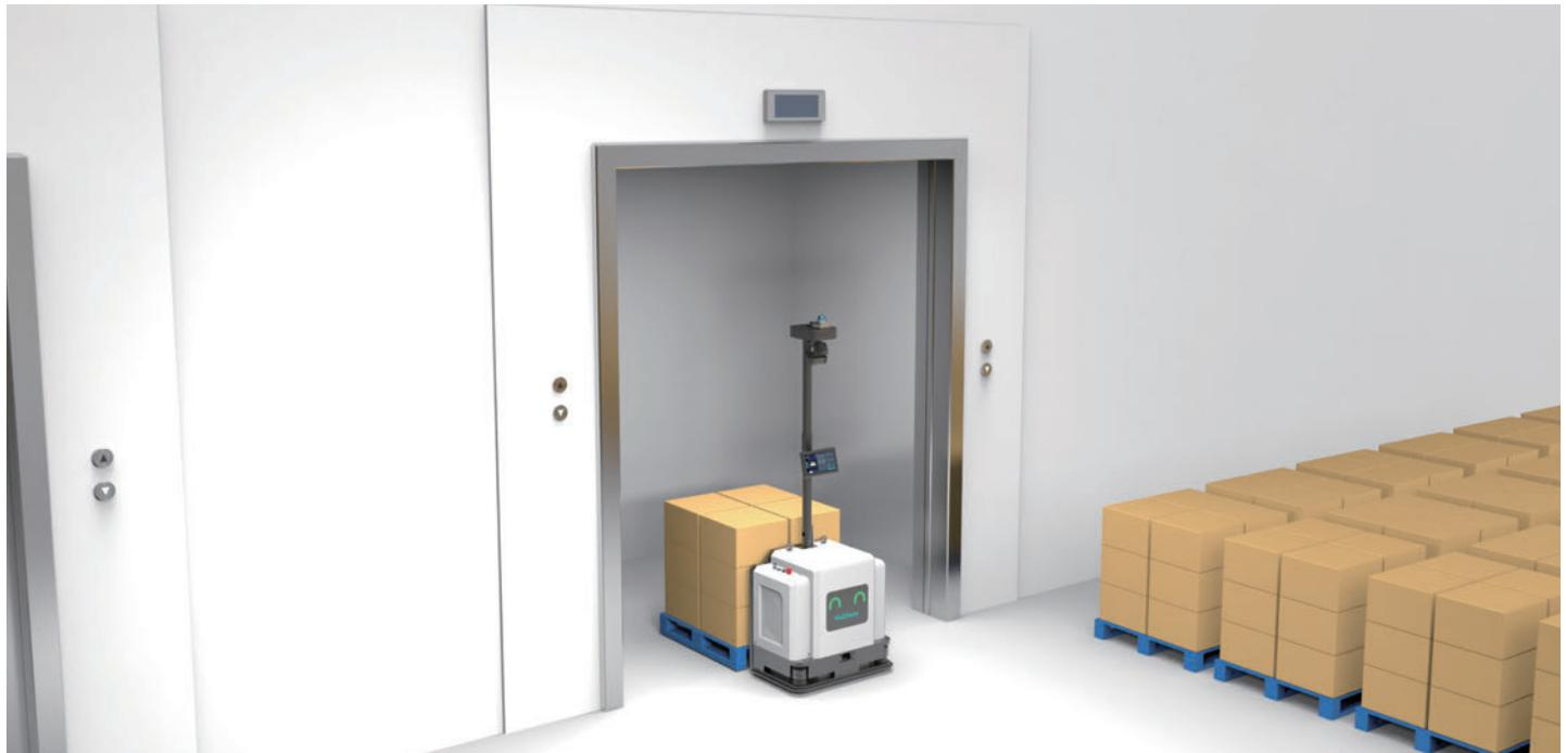
フロア間での搬送機能を備え、多層フロア、多エリアの資材輸送需要を満たし、設備制御システムMW-WCSを通じて自らエレベーターや自動ドアと信号交換を行い、エレベーター乗り降り、自動ドアなどのフロア転換とエリア転送の動作を自動的に完了します。
